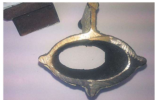
28 aastat vana radiaatori läbilõige küttesüsteemis, mis kolm aastat on töötanud Baueri seadme-ga.
