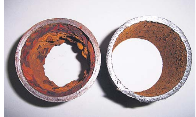
Toru enne (vasakul) ja pärast baueri seadme paigaldamist.
