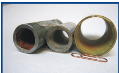
Tsingitud toru enne ja 6 kuud pärast Bauer AK paigaldamist Kadriorus.
