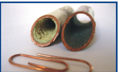
Vasktorunäidised enne ja pärast Bauer PJ kasutusele võtmist.
