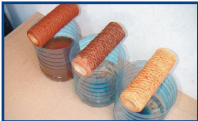
Süsteemis kasutusel olnud filtrid ja veenäidised enne, 6 ja 12 kuud pärast Bauer AK paigaldamist.
