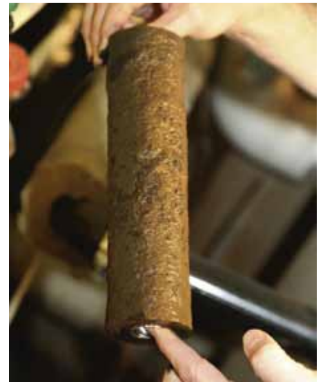
2 aastat vana küttesüsteem, filter täitus 4 kuuga.
