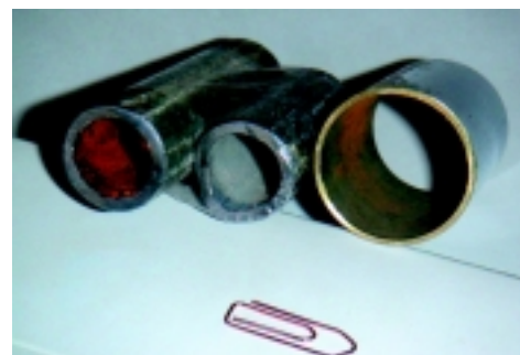
Tsingitud torud enne ja kuus kuud pärast Bauer AK paigaldamist Kadrioru korteriühistusse; parempoolne on tükk puhtaks saanud kätärätikuivatist
